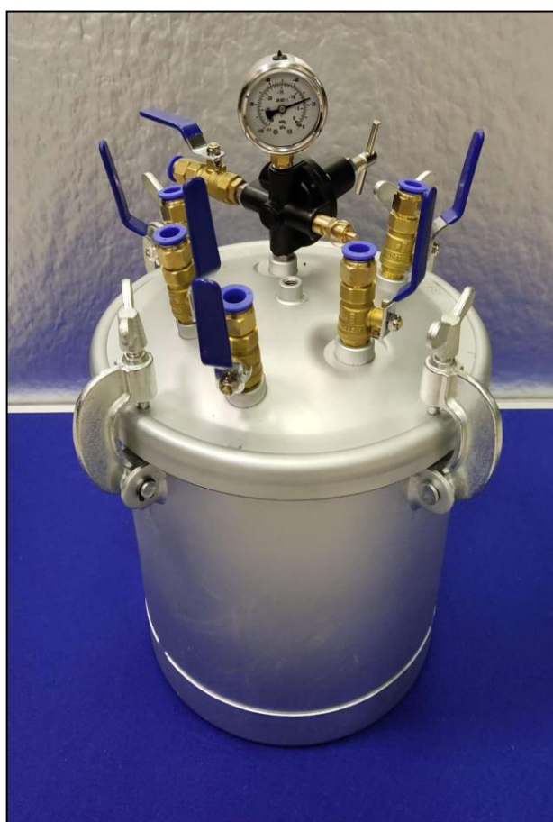
Ловушка с установленными фитингами
