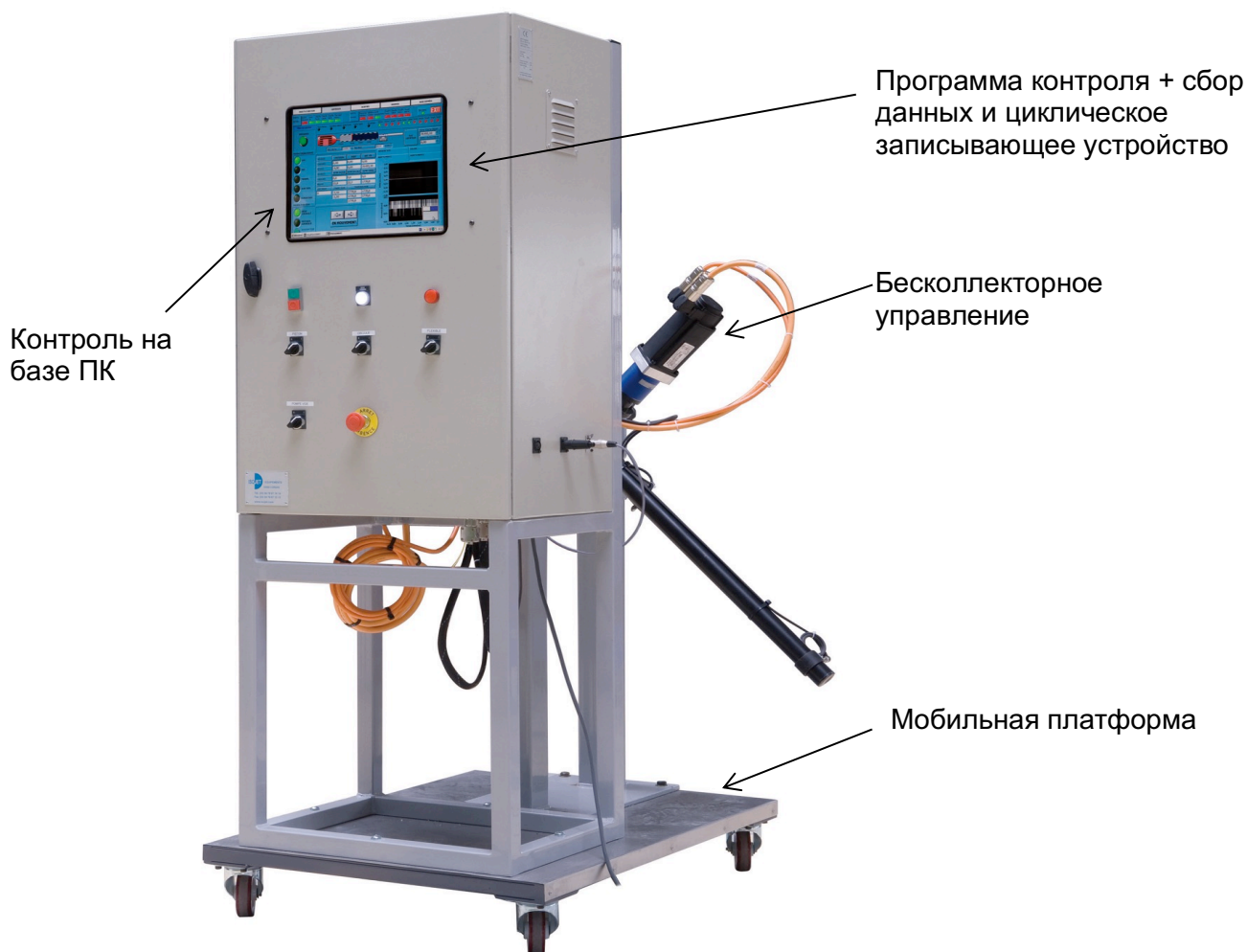
Рисунок 2: RTM установка с ПЛК (комплектация установки может быть изменена в соответствии с тех. заданием заказчика)
