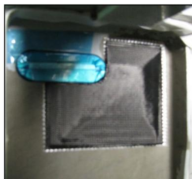
Рисунок 3: Ремонт алюминиевой балки пола ATR-72 с использованием приклеенной углеродной заплаты, выполненный на месте компанией GMI Аега, в сотрудничестве с компанией ATR.
