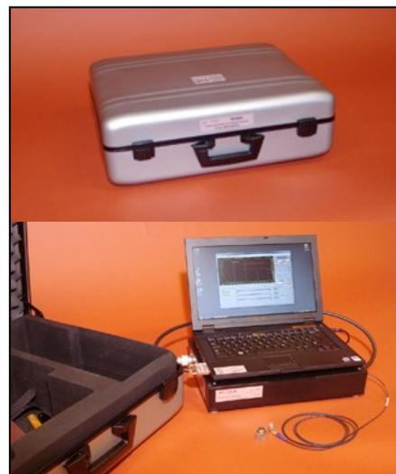
Сам ультразвуковой измерительный прибор подходит для работы на углеродных структурах. Он легкий, компактный и предоставляет всевозможные способы современной обработки данных блоком, встроенным в компьютер. Система разработана таким образом, чтобы можно было обнаружить расслоение и определить его местоположение с точностью до слоя.
