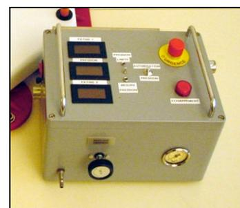
Как правило, использование только вакуумного мешка ведет к теоретически максимальному вакууму под мешком, приблизительно 30 дюймов ртутного столба (- 1 бар). При этом сочетание сил вакуума под обычным мешком и давления со стороны установки «ОЛЬГА» приводят к оптимальным силам сжатия от 30 до 40 фунтов на квадратный дюйм (от 2 до 2,5 бар). Применяется непосредственно для ремонта композиционного материала, а также для склеивания металла.
