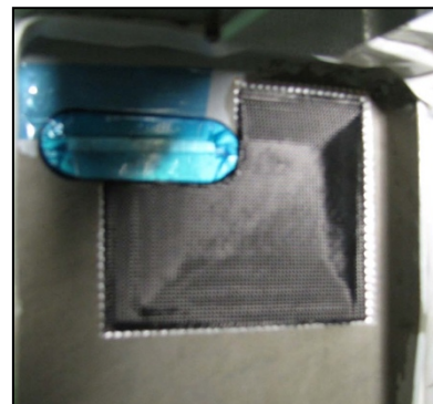
Рисунок 3: Ремонт алюминиевой балки пола ATR-72 с использованием приклеенной углеродной заплата, выполненный на месте компанией GMI Aero, в сотрудничестве с компанией ATR.
