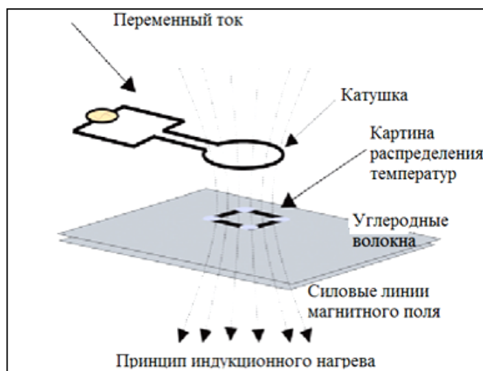
Рисунок.1 Схема процесса индукционного нагрева для полимеризации ПКМ
