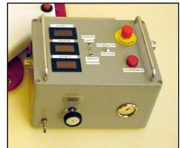
Как правило, использование только вакуумного мешка ведет к теоретически максимальному вакууму под мешком, приблизительно 30 дюймов ртутного столба (- 1 бар). При этом сочетание сил вакуума под обычным мешком и давления со стороны установки «ОЛЬГА» приводят к оптимальным силам сжатия от 30 до 40 фунтов на квадратный дюйм (от 2 до 2,5 бар). Применяется непосредственно для ремонта композиционного материала, а также для склеивания металла.
