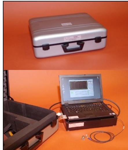
Сам ультразвуковой измерительный прибор подходит для работы на углеродных структурах. Он легкий, компактный и предоставляет всевозможные способы современной обработки данных блоком, встроенным в компьютер. Система разработана таким образом, чтобы можно было обнаружить расслоение и определить его местоположение с точностью до слоя.
