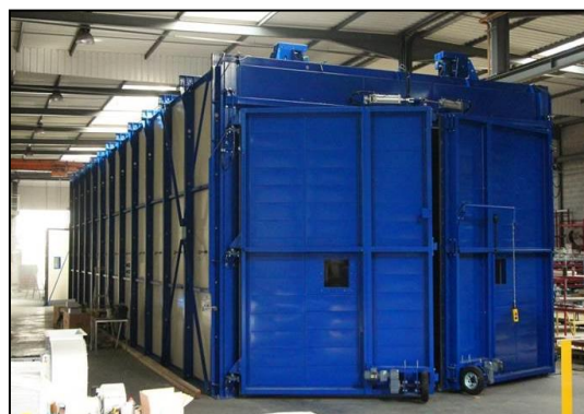
Тепловой модуль: 6×22×4м, объем 528м 3 , Рабочая Т=220°C
