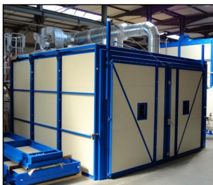
Тепловой модуль: 5,5×6×3м, объем 99м 3 , Рабочая Т=220°C
