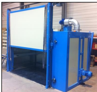
Тепловой модуль: 2,1×1,1×1,3м, объем 3м 3 , Рабочая Т=250°C
