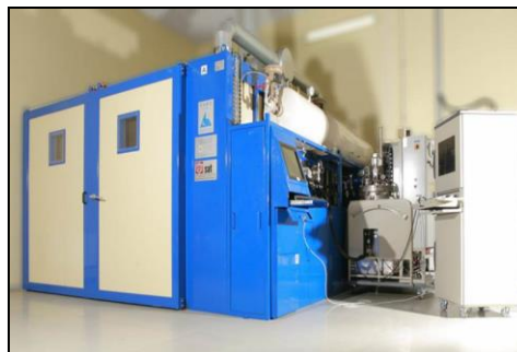
Тепловой модуль: 3×4×2м, объем 24м 3 , Рабочая Т=220°C
